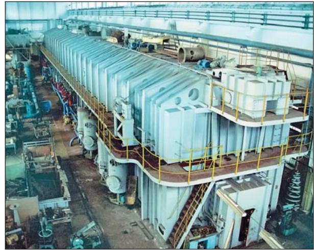
Рис.3. Кавитационный бассейн Крыловского государственного научного центра. Хорошо видна внешняя герметичная оболочка бассейна, внутри которой можно создавать разрежение воздуха и за счет этого менять числа кавитации исследуемых объектов.
