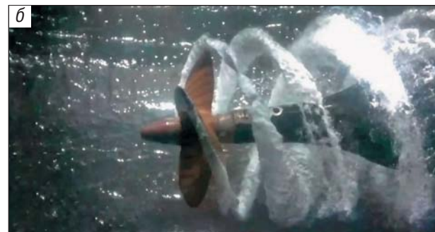
Рис.1. Различные стадии кавитации на гребных винтах: начальная (а) и развитая (б). Сначала формируется небольшая каверна на кромке лопасти гребного винта, а также возникает кавитация концевой вихря лопасти (а). Развитая кавитация засасывающей поверхности лопасти гребного винта выражается в развитии больших каверн, захватывающих большую часть поверхности лопасти. Сходящая вихревая пелена содержит значительное число паровых пузырей (б).
