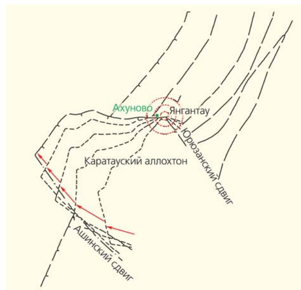
Схематический рисунок смещения по надвигам в районе горы Янгантау [7].
