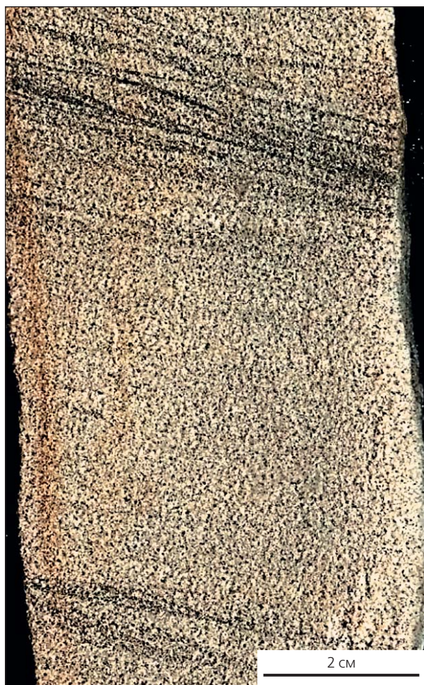
Рис.14. Наклонно-слоистая текстура пижемской ильменит-лейкоксовой руды состава (%): \text{SiO}_2 — 82.64, \text{TiO}_2 — 5.26, \text{Al}_2\text{O}_3 — 5.11, \text{Fe}_2\text{O}_3 — 1.00, \text{FeO} — 1.50, \text{MgO} — 0.46, \text{CaO} — 0.23, \text{K}_2\text{O} — 1.36, \text{Na}_2\text{O} — 0.5, потери при прокаливании — 1.95; сумма — 100.01. Сканограмма образца.
