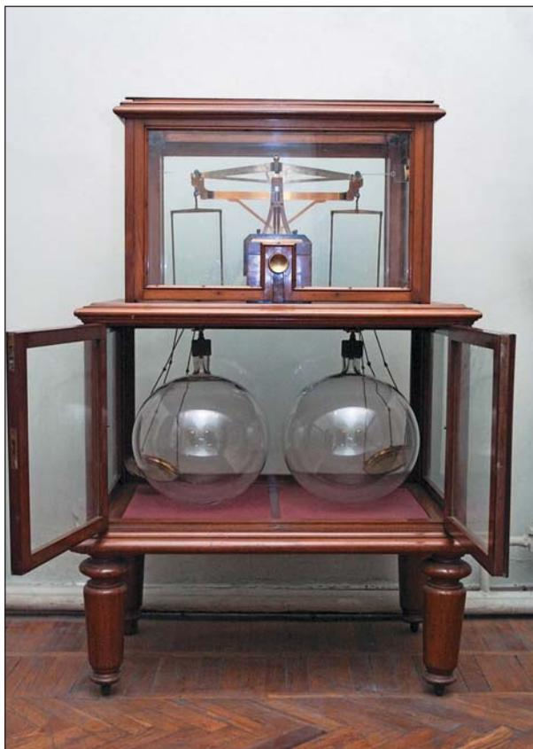
Двухъярусные весы для взвешивания газов конструкции Менделеева.
