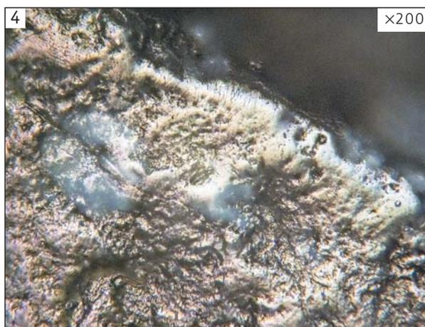
Результаты трасологического анализа скребла со стоянки Мухкай IIa. На рисунке скребла красными стрелками указаны участки рабочего лезвия орудия и чистой поверхности без следов, которые фотографировались под микроскопом. Черным точечным пунктиром над скреблом указана зона распространения микроизноса и его интенсивность. Микрофотографии участков поверхности орудия: 1 — «чистая» поверхность; 2–4 — участки кромки лезвия орудия со следами износа.
