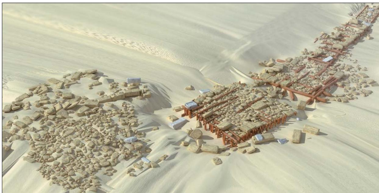
3D-реконструкция фундамента-ряжа портового сооружения.
