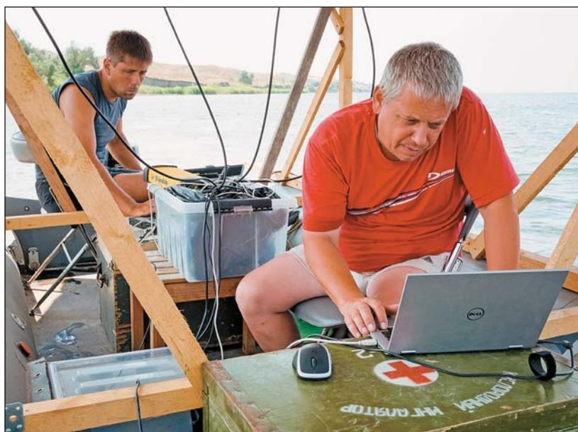
Профилирование донных отложений профилографом Trittech SeaKing.
