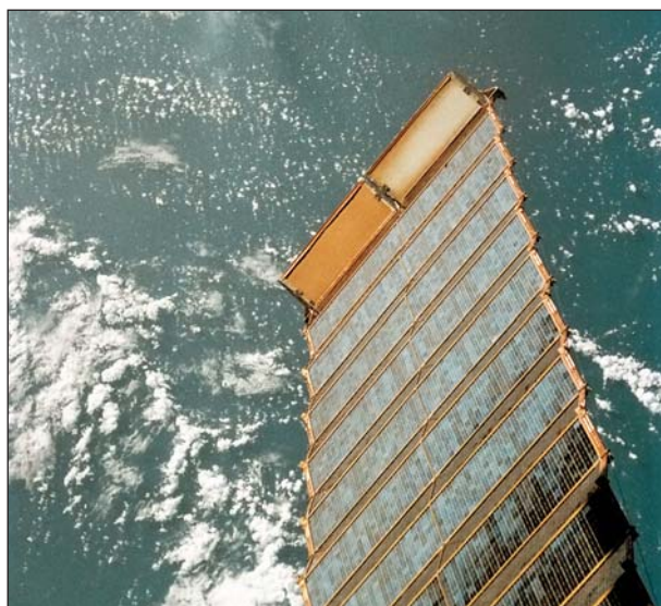
Солнечная батарея многоразового раскрытия орбитального комплекса «Мир». Для создания и эксплуатации крупногабаритных космических конструкций в Институте электросварки были разработаны новый вид сварки и специальная монтажная аппаратура. Удлиненная солнечная батарея доставлялась на орбиту в сложенном виде и затем полностью раскрывалась в космосе. 1998 г.
