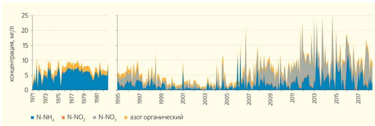
Рис.4. Динамика концентрации минеральных соединений азота в воде створа «Коломна» Москва-реки в 1995–2018 и в 1971–1982 гг.
