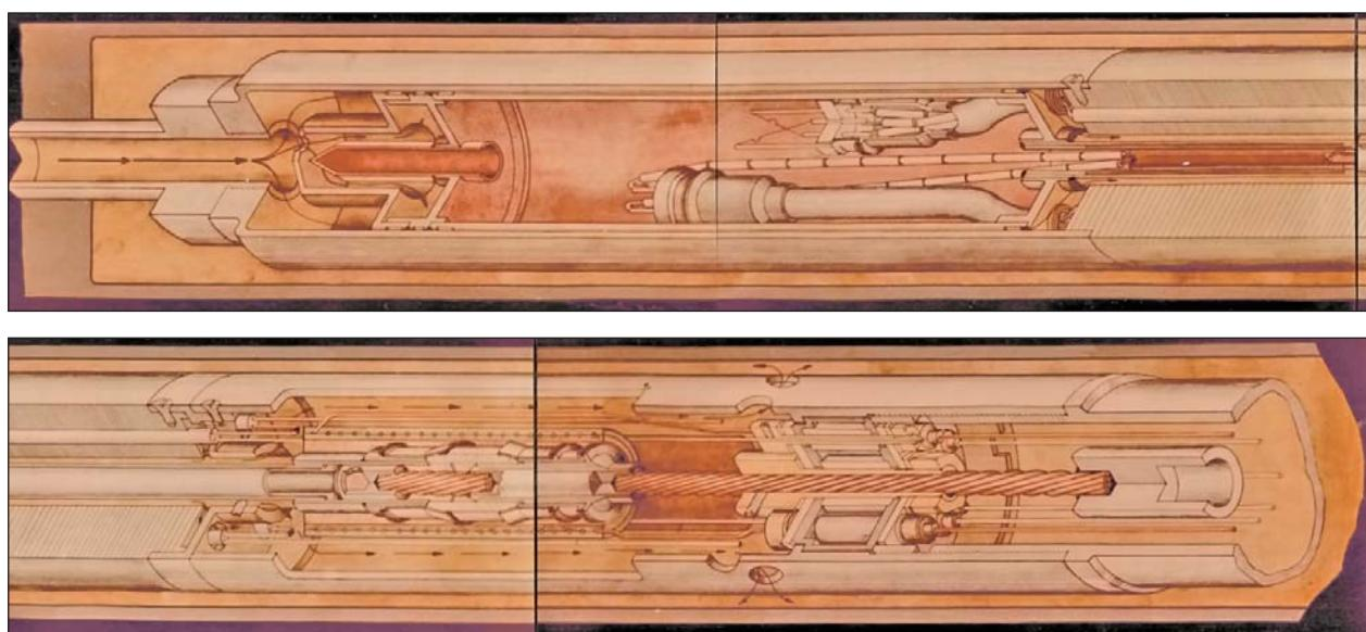
Рис.7. Схема трехэлементного ЭГК типа «Гвоздь», который монтировался на специальной штанге и устанавливался вертикально в петлевом канале реактора. Нижняя часть — продолжение верхней.
