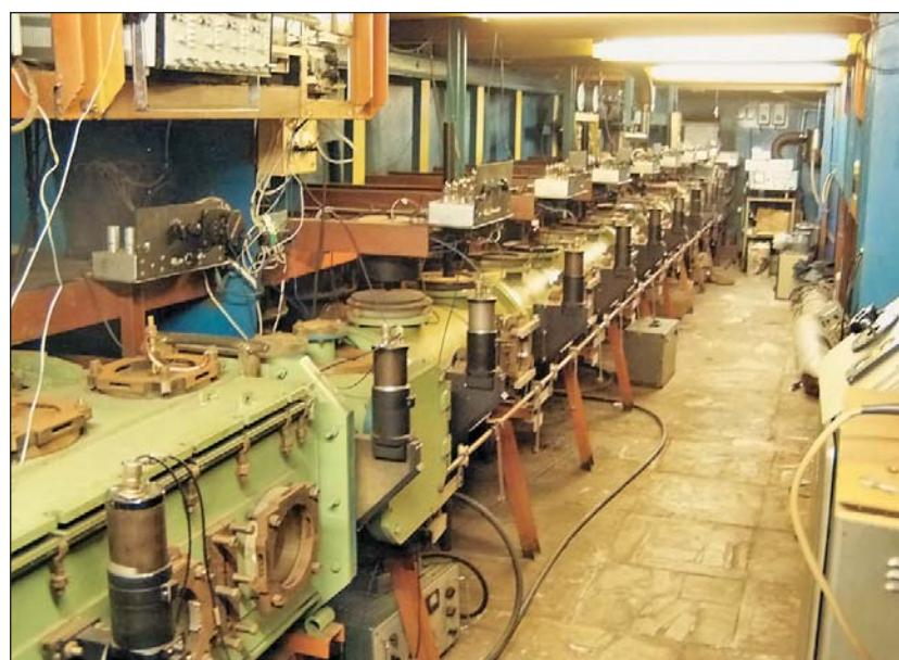
Рис.4. Малая баллистическая установка лаборатории.
