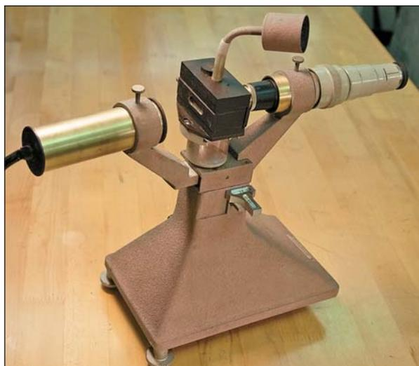
Прибор Милликена для наблюдения за движением капель масла в электрическом поле. Состоит из источника света, конденсатора и микроскопа.
