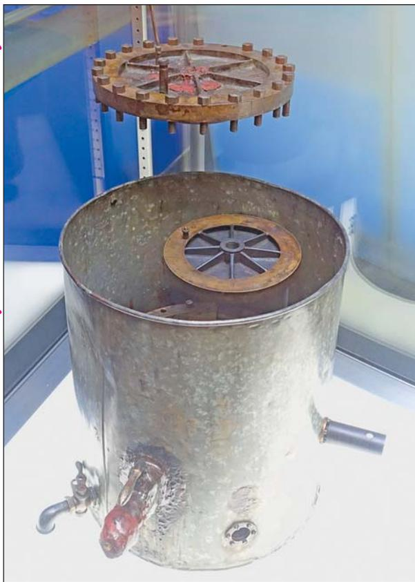
Прибор Милликена для наблюдения за движением капель масла в электрическом поле. Примерно 1916 г. Устройство использовалось Р.Миллиkenом и Х.Флетчером в нескольких экспериментах по измерению значения заряда электрона. Экспонат Музея науки и промышленности в Чикаго (США).
