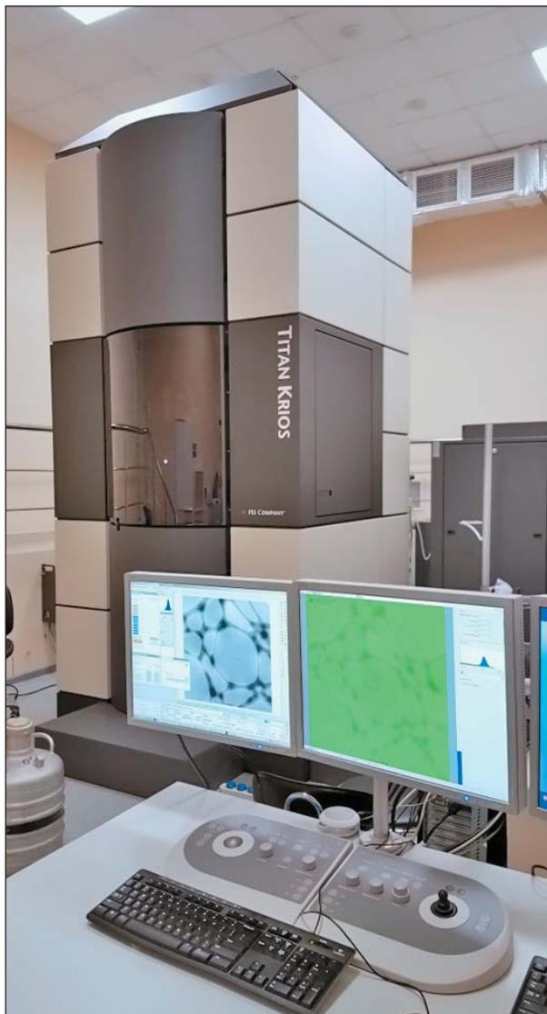
Рис.1. Просвечивающий микроскоп Titan Krios (FEI, США).
