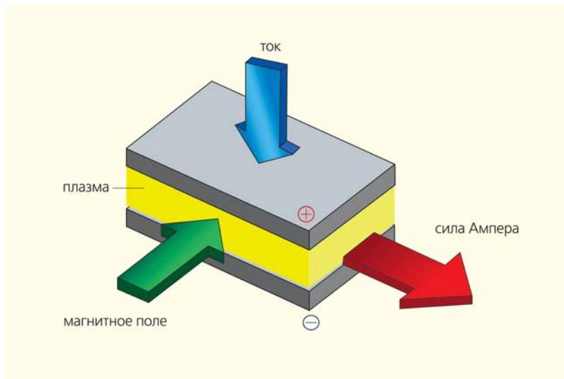
Рис.8. Принцип работы плазменного МГД-ускорителя.
