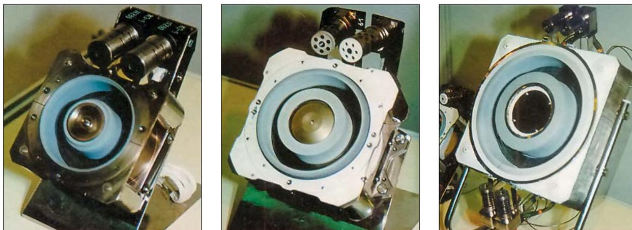
Рис.6. Линейка двигателей СПД разработки ОКБ «Факел» (г.Калининград) [7]. Слева направо: СПД-70, СПД-100, СПД-200 (индекс означает диаметр выходного канала в миллиметрах).
