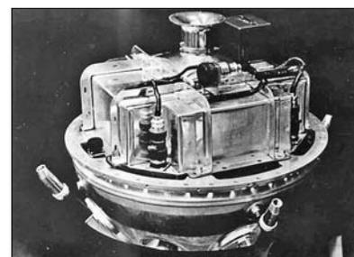
Узлы простейшего спутника: радиопередатчик, блок источников питания, вентилятор системы терморегулирования и коммутационный блок.
