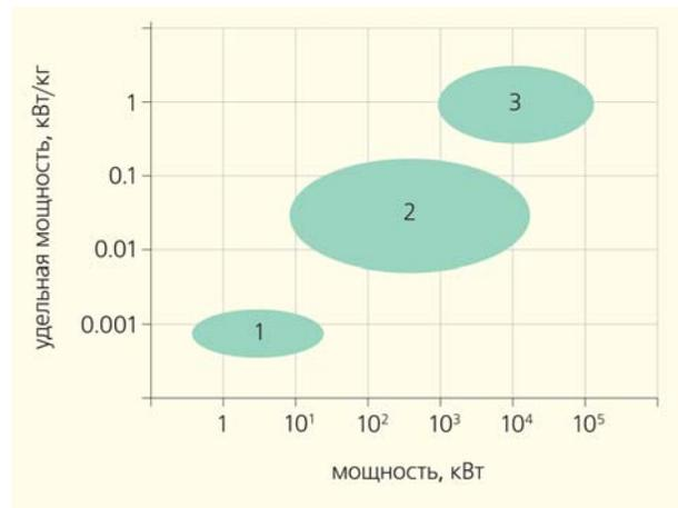
Рис. 1. Требования к параметрам двигательной системы в соответствии с миссией КЛА. Аппараты и задачи: 1 — современные спутниковые системы, связь, наблюдение; 2 — межорбитальные буксиры, создание лунной базы, астероидный контроль, глобальные системы связи и контроля; 3 — дальние грузовые и пилотируемые полеты, зондирование дальнего космоса.
