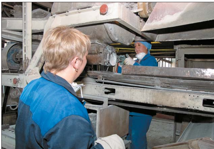
Узел формования катализаторов в форме экструдатов. Производство катализаторов такого вида повышает производительность их наработки по сравнению с выпуском катализаторов в форме таблеток и колец с помощью таблетмашин. Катализаторы-экструдаты применяются в различных реакторах.
