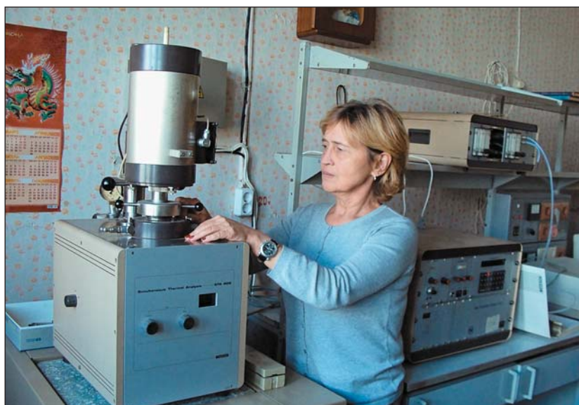
Установка для определения температуры разложения компонентов катализаторов на воздухе и в восстановительных средах (в водороде). Эти исследования позволяют решать вопросы выбора температур прокаливания и активации катализаторов.
