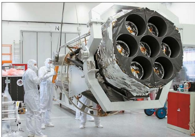
Рис.10. Общий вид телескопа еРозита обсерватории Спектр-Рентген-Гамма. Высокая чувствительность и большое поля зрения позволяют вести поиск переменных источников во время обзора всего неба (снимок печатается с разрешения Института внеатмосферной физики общества Макса Планка — МПЕ).
