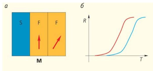
Рис.5. Спиновые вентиля. Структура спинового вентиля (а) и сдвиг температурной зависимости его сопротивления при изменении взаимной ориентации магнитных моментов в соседних слоях (б).
