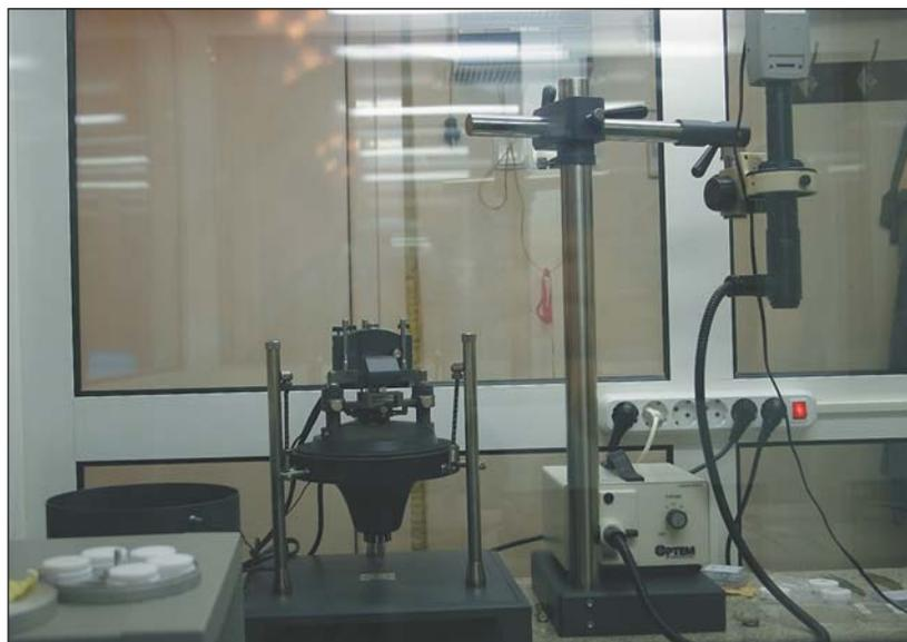
Рис.2. Так выглядит изнутри климатический бокс «TRACKPORE ROOM», который позволяет проводить АСМ-измерения в контролируемых условиях окружающей среды.
