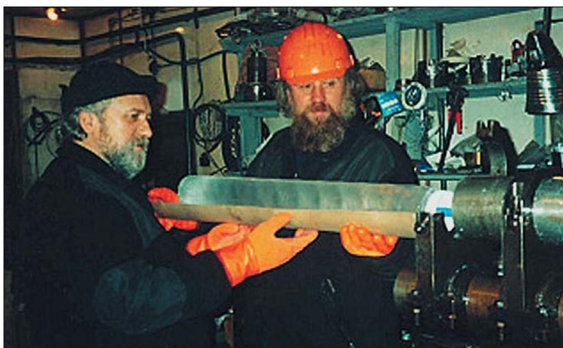
Бурение глубокой скважины на ст. Восток продолжается: старший инженер А.В.Красилев и научный сотрудник В.М.Зубков извлекают керн из электромеханического бурового снаряда КЭМС-132. Январь 2006 г.
