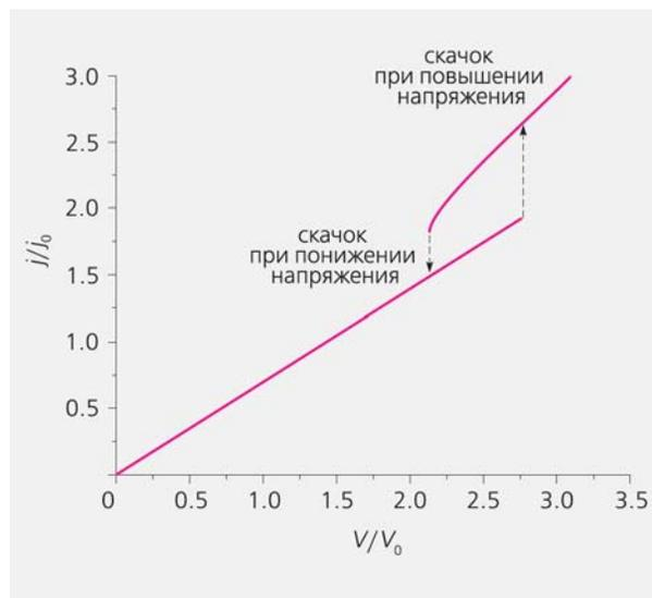
Рис.8. Бистабильная вольтамперная характеристика магнитного перехода ( $j_0$  — пороговая плотность тока,  $V_0$  — напряжение на переходе при пороговой плотности тока для параллельной конфигурации перехода).
