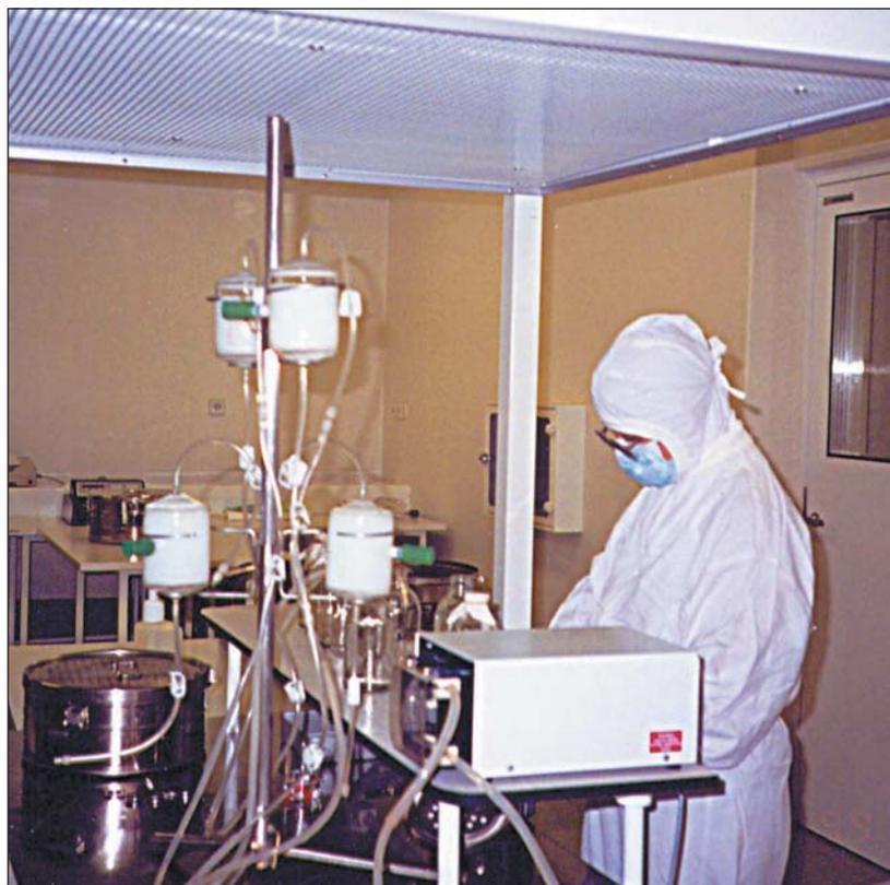
Завершающая производственная стадия — заполнение колонок сорбентом.
