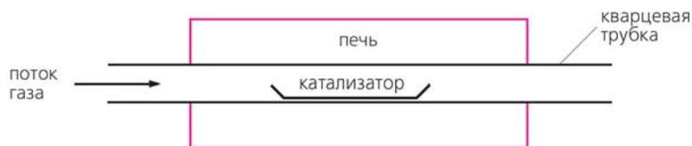
Рис.4. Схема установки для получения нанотрубок методом химического осаждения.
