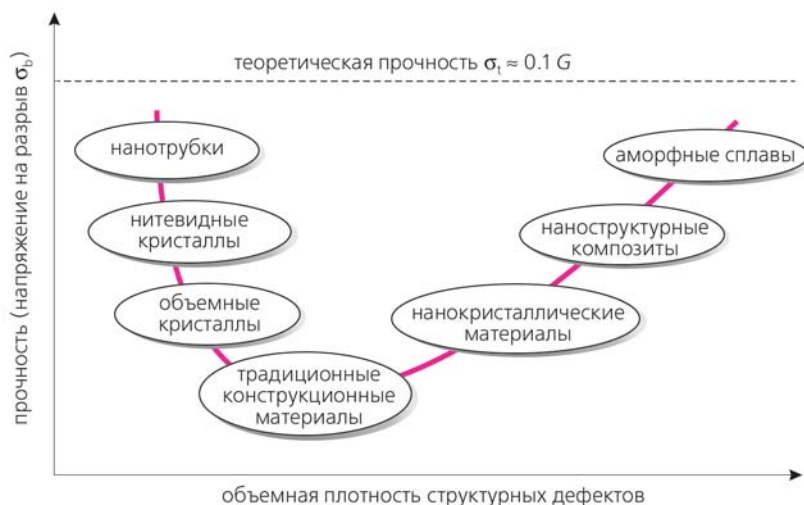
Схематическая зависимость прочности от плотности атомарных дефектов в материале. G — модуль сдвига.
