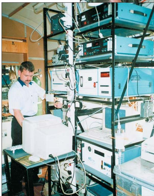
Оснащение экспедиции 1999 г. Слева — газоанализатор, справа — уникальный четырехканальный газовый хроматограф для измерения концентрации в воздухе парниковых газов и веществ, разрушающих озоновый слой. На заднем плане — группа приборов для измерения концентрации и микрофизических свойств аэрозолей.
