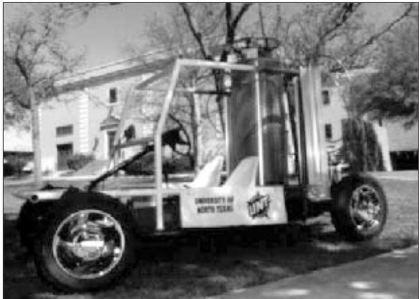
Опытный образец криогенного автомобиля, разработанный в Университете штата Северный Техас. Он состоит из бака с жидким азотом, теплообменника, в котором происходит кипение азота с последующим подогревом паров до температуры, близкой к комнатной, и пневматического двигателя. По принципу действия этот вид транспорта скорее похож на паровоз, с той лишь разницей, что энергия для парообразования берется из окружающей среды.
